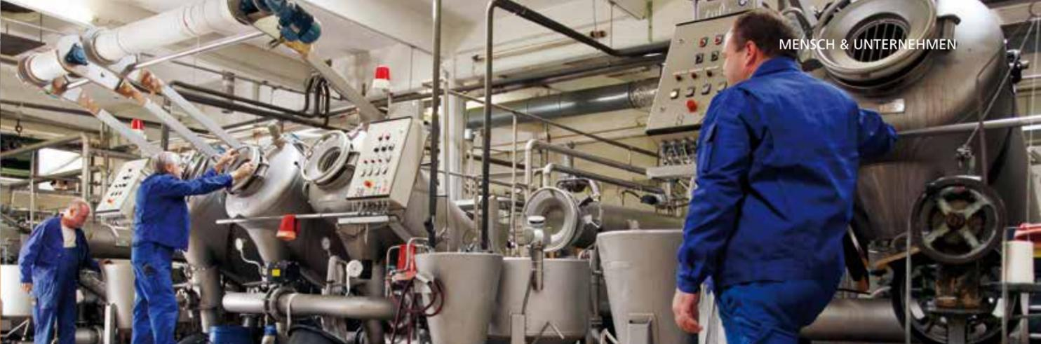
Mittels Tauch- und Beschichtungsverfahren entstehen bei Blanke Textech diverse Stoffe mit unterschiedlichen Eigenschaften wie Flammschutz, Elektrosmog abschirmend oder feuchtigkeitsregulierend.
